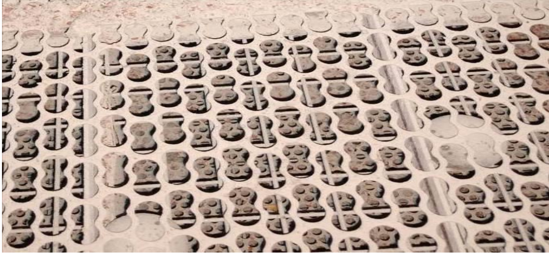
Рисунок 1 – Загальний вид решета з отворами у формі овалу Кассіні
