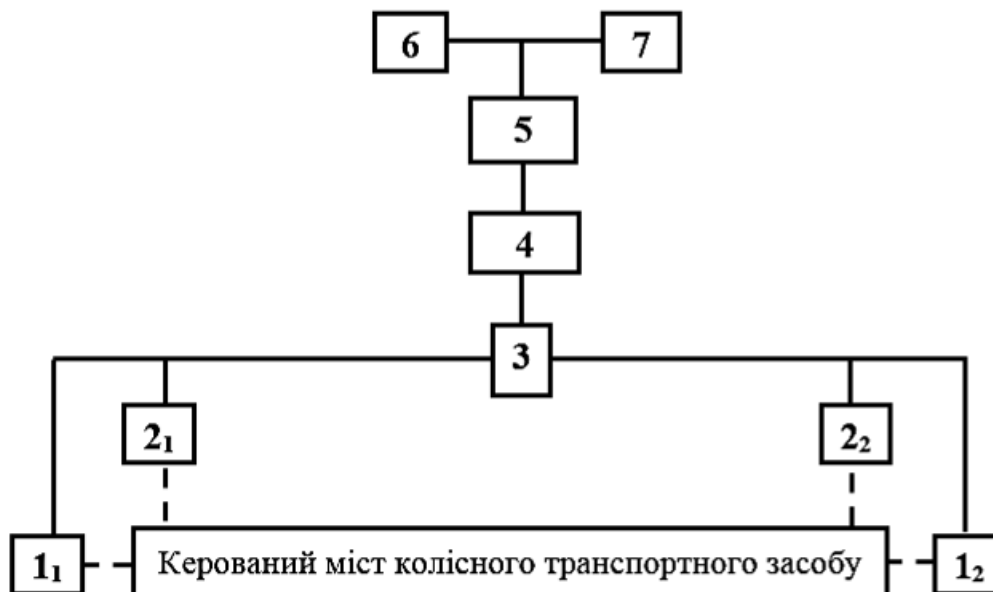
Рисунок 1 - Система бортового діагностування керованих мостів колісних транспортних засобів
