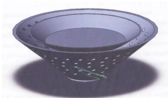
Рисунок 1 – Схема перфорованого конуса з обертальним робочим органом (диском)
