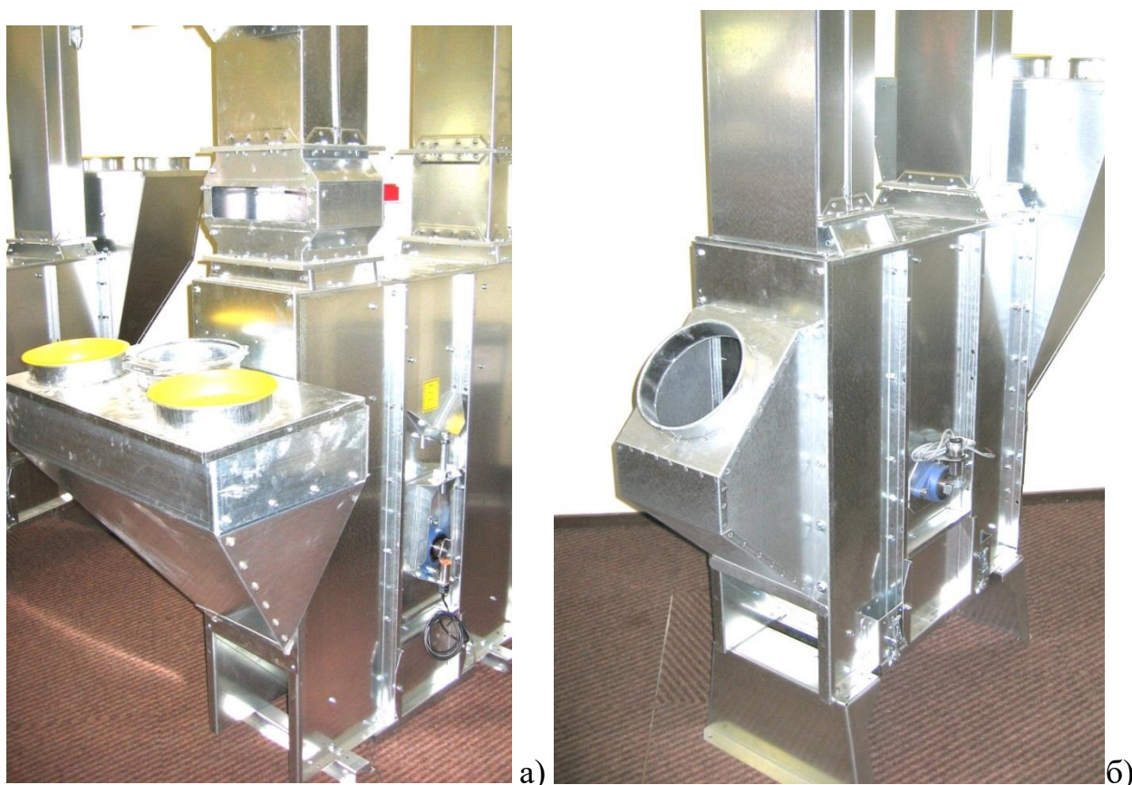
Рисунок 4.23 – Типові завантажувальні частини норій під пряму та косу подачу матеріалу
