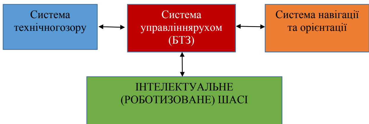
Рисунок 1 – Типова функціональна схема основних підсистем автоматичної системи керування БТЗ
