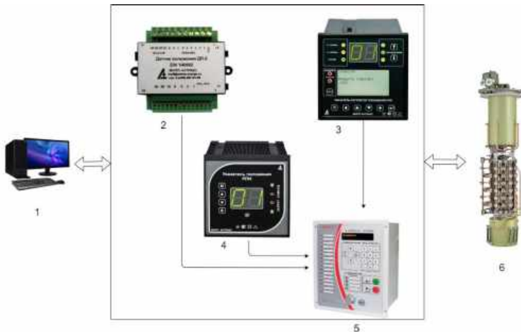
Рис. 1 – Структура випробувальної системи «Релсіс РЗЛ-05.РПН»: 1 – ПК; 2 – датчик положення привода ДП 5; 3 – показчик регулятор положення РПН; 4 – показчик положення РПН; 5 – пристрій мікропроцесорний для автоматичного управління РПН трансформатора «Релсіс РЗЛ-05»; 6 – РПН трансформатор
