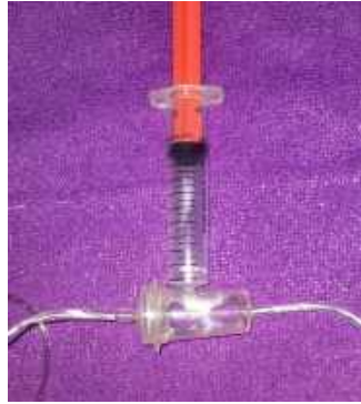
Рис. 1 – Модель придаткової пазухи для дослідження промивання патологічного секрету
