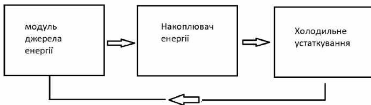
Рис. 1 – Схема роботи мобільної автономної холодильної установки.
