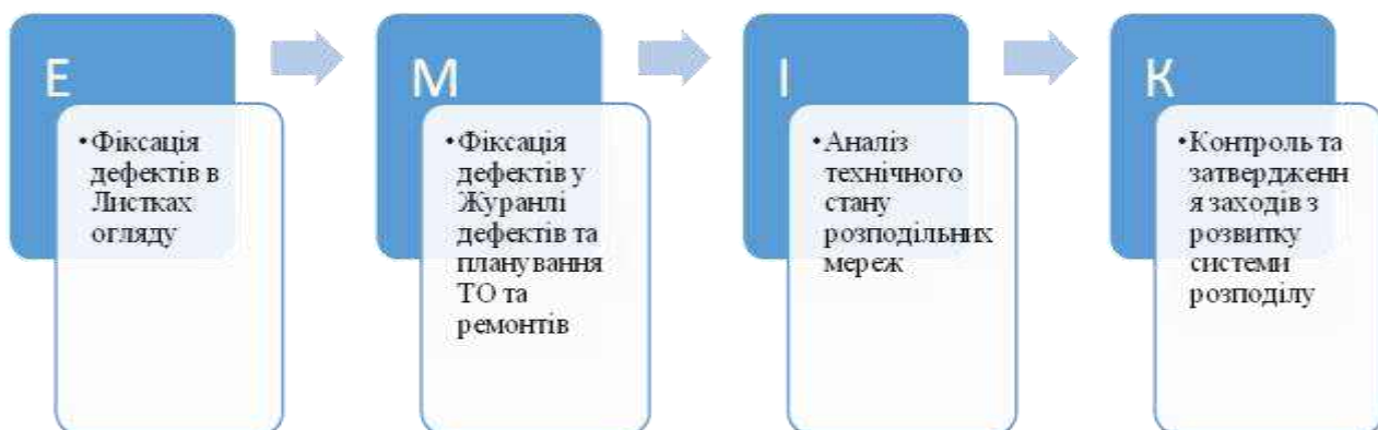
Рисунок 1 – Узагальнена схема процесу моніторингу технічного стану розподільних мереж ОСР
