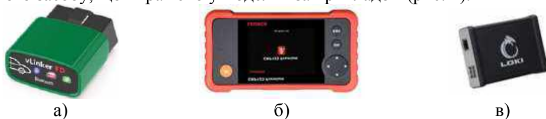
Рис. 1. Приклад діагностичного обладнання: а) Марочний діагностичний прилад vLinker FD, сумісний з маркою Ford, б) Мультимарочний діагностичний прилад Creader Professional в) Індивідуальний діагностичний прилад Loki для електромобілів Tesla.
