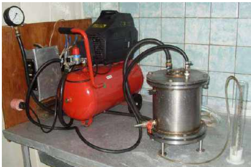
Рис. 2.4. Зовнішній вигляд ультрафільтраційної лабораторної установки на основі мембранного модуля із барботуючим пристроєм
