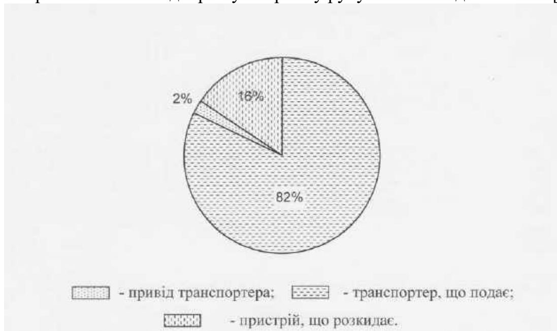
Рис. 1. Структура відмов механізмів причепа-розкидача РТД-5
