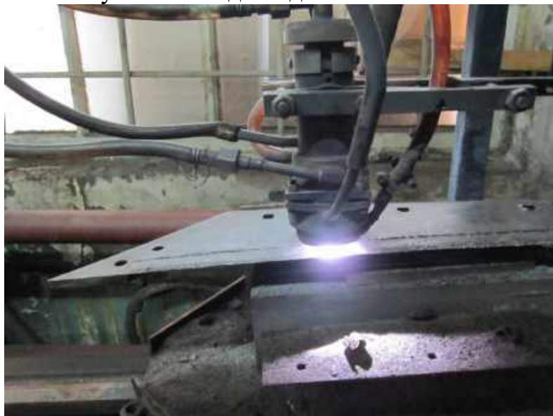
Рис. 1. Технологічний процес нанесення зносостійкого твердосплавного покриття плазмовим наплавленням у середовищі стисненого повітря на лезо лемеша
