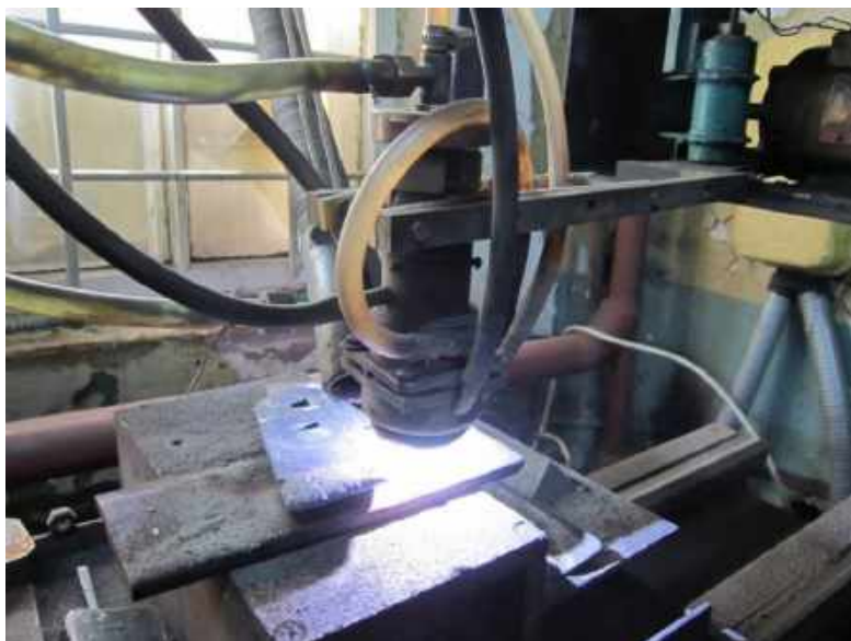
Рис. 2. Технологічний процес нанесення зносостійкого твердосплавного покриття плазмовим наплавленням у середовищі стисненого повітря на лезо долота
