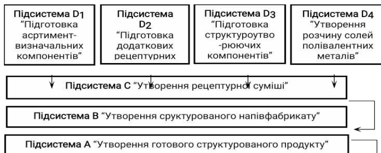
Рис. 1. Блок-схема технологічного процесу виробництва структурованих продуктів
