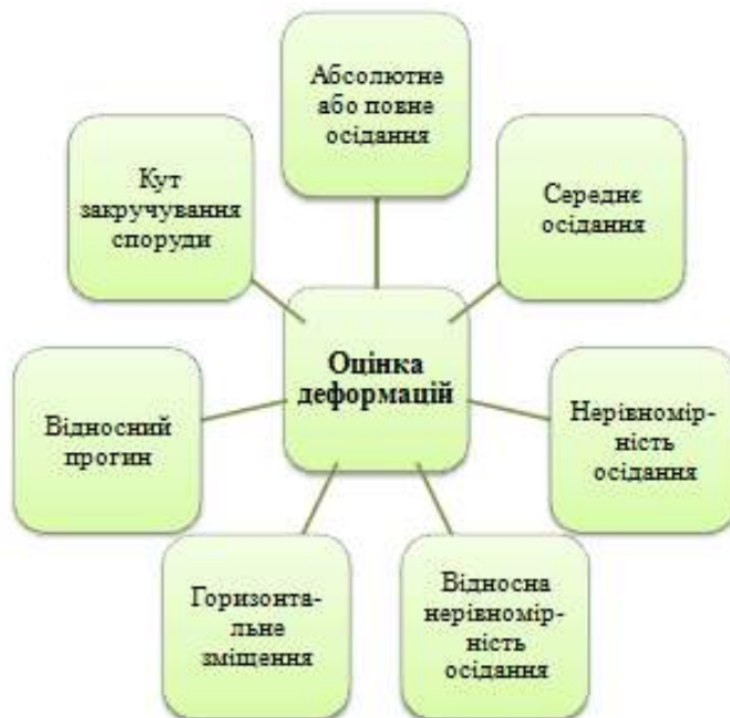
Рисунк 1 – Параметри оцінки деформацій споруд
