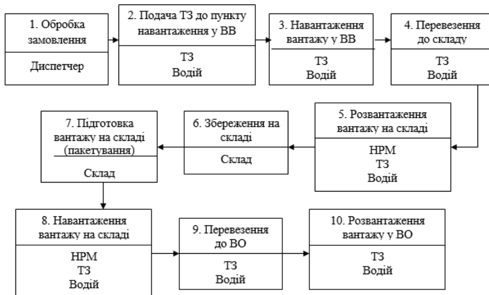
Рис.1 – Схема технологічного процесу доставки сільськогосподарських вантажів у транспортних пакетах з урахуванням задіяних ресурсів
