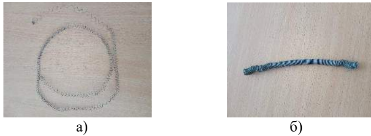
Рисунок 1 – Термообробка елемента з ефектом пам'яті форми на основі Ni–Ti а) – сплав після термообробки в розтягнутому вигляді; б) вигляд сплаву після занурення в теплу воду;
