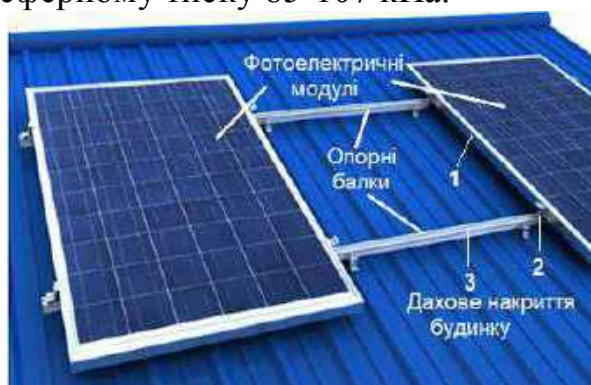
Рис. 2 - Кріплення фотомодулів на похилій покрівлі житлового будинку
