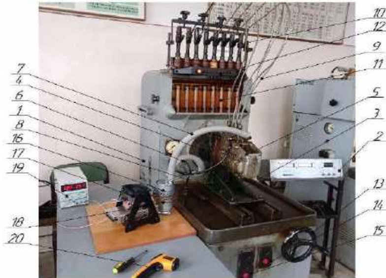
Рис. 2 Стенд для дослідження роботи паливної системи ДВЗ в умовах низьких температур:
