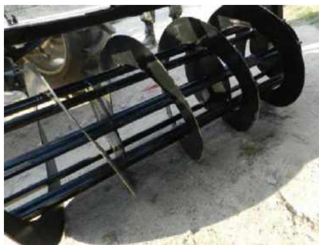
Рис. 2. Загальний вигляд робочої поверхні борони з гвинтовими робочими органами
