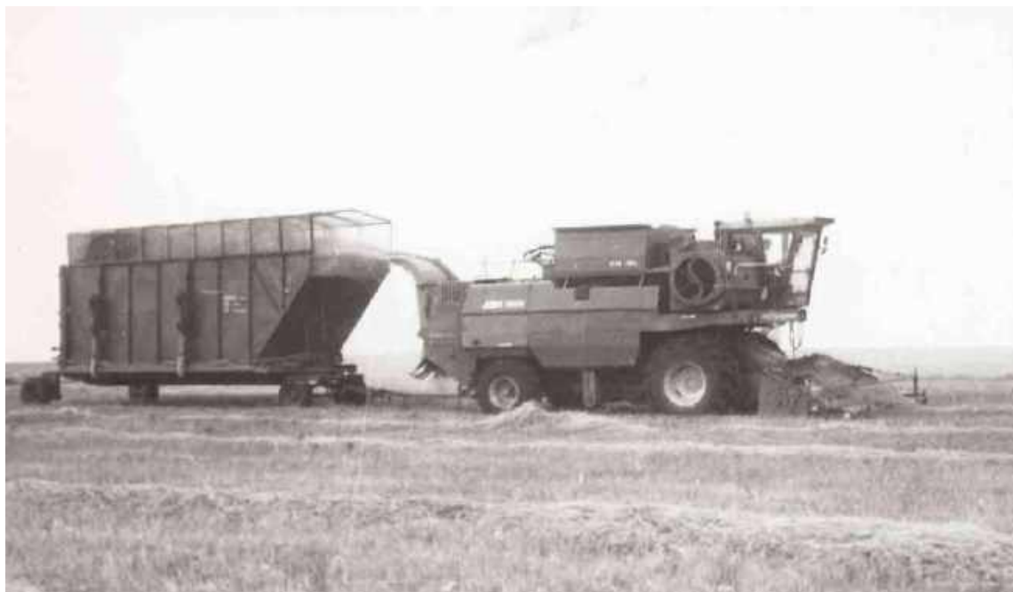
Рисунок 1. Збирання соломи після молотарки комбайна в причіп
