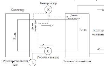
Рис.2 - Структурна схема роботи сонячного колектора
