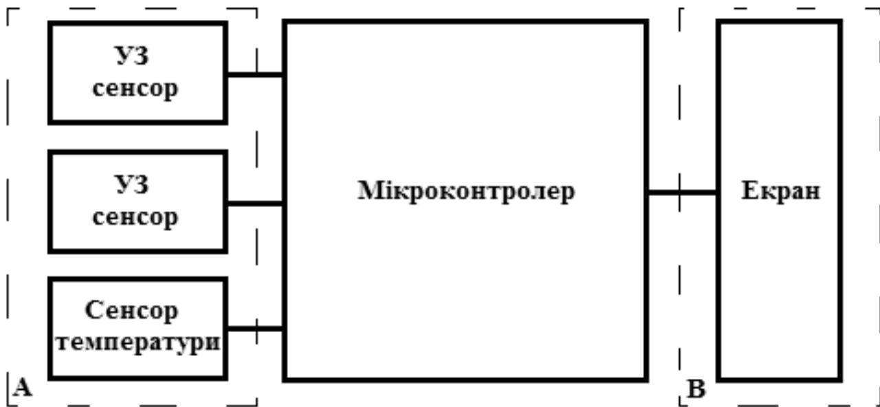
Рис.1 - Структурна схема мікроконтролерної системи
