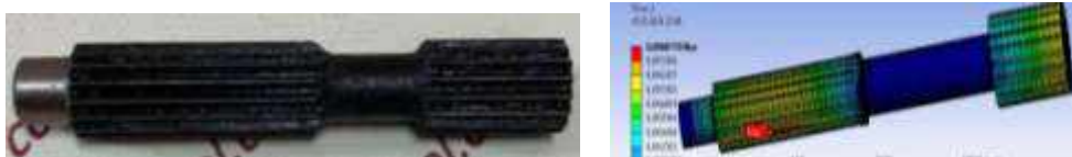
Рис. 1. Конструкція та скінчено-елементна модель валу насоса
