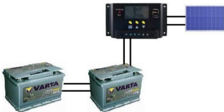
Рисунок 1 - Схема підключення АКБ
