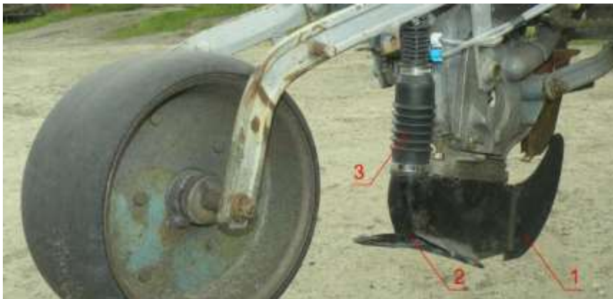
Рис. 1. Посівна секція для внутрішньоґрунтового післяпосівного внесення попередньо спіненого гербіциду: 1 – полозовидний сошник; 2 – стрільчастий подовжувач сошника; 3 – піногенератор
