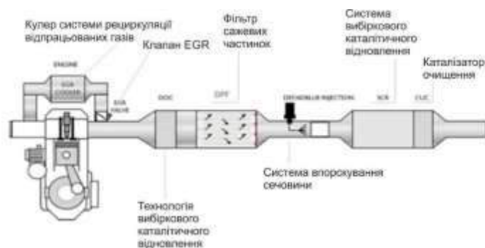
Рис. 2 – Схема системи нейтралізації для легкої сільськогосподарської та будівельної техніки, що працює за технологією STAGE IV/TIER 4B COMPACT HI-E SCR
