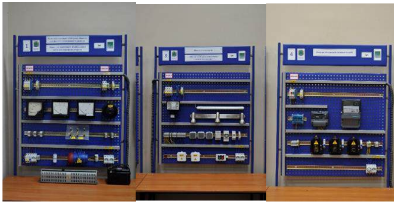
Рис. 1. Монтаж комутаційно-захисних апаратів, освітлення та лічильника
