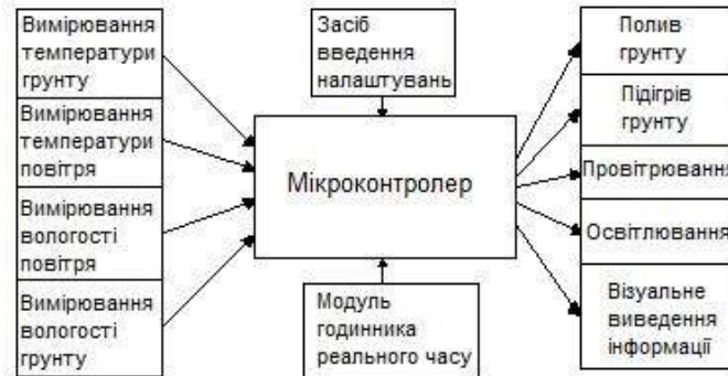
Рис. 1 - Структурна схема автоматизації теплиці.
