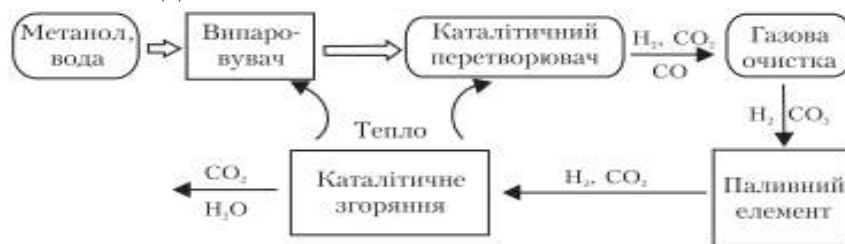
Рис.2 – Принцип роботи паливного елемента
