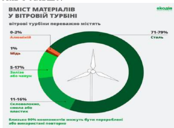
Рис. 2 – Вміст матеріалів у вітровій турбіні
