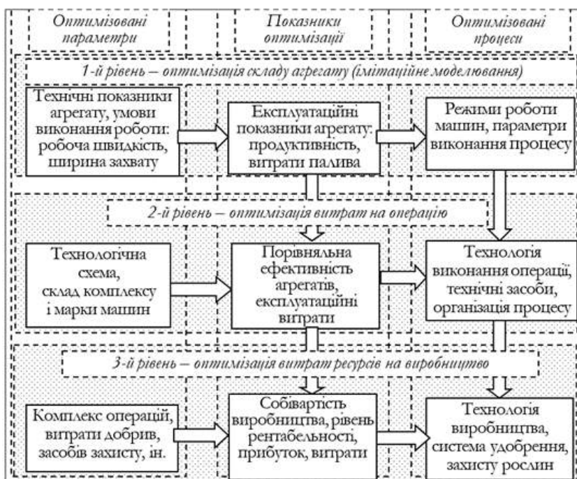
Рис. 1. Концептуальна схема системної оптимізації використання виробничих ресурсів у рослинництві
