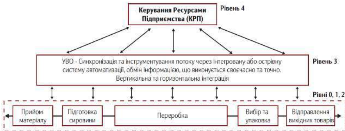
Схема 1 – Обмін даними в цуровому виробництві та рішення щодо оптимізації на відповідних рівнях ISA-95.
