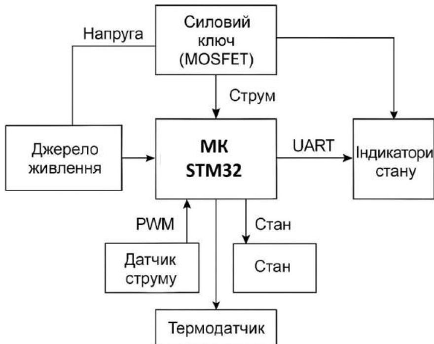
Рис. 1. Структурна схема модуля зарядки на базі мікроконтролера
