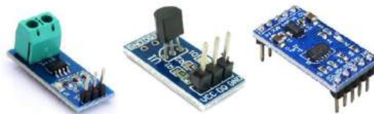
Рис. 1. Датчики: ACS712, температурний DS18B20, вібрації ADXL345
