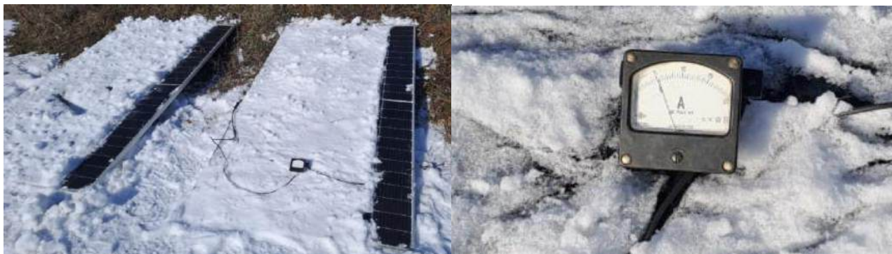
Рис. 2. Початок експерименту 23.02.2025, 13:00. Ліворуч – візуальна фіксація панелей; праворуч – показ струму короткого замикання 5 А
