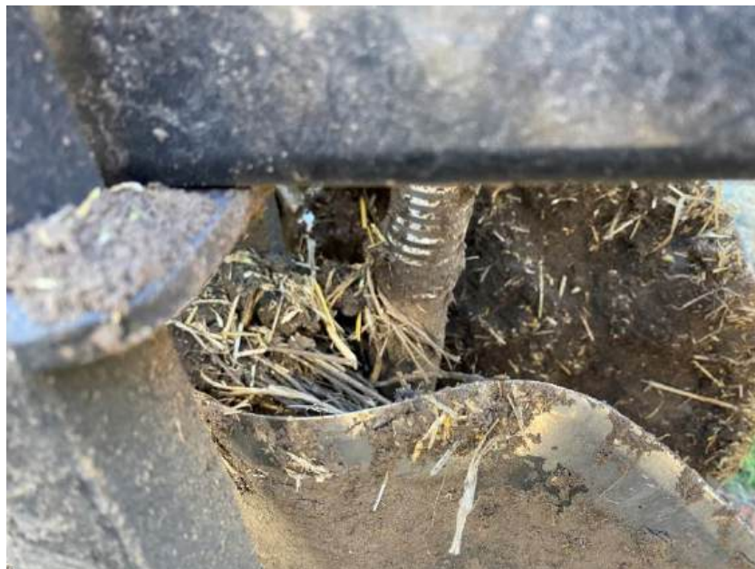
Рис. 5. Забивання між лапою та закриваючим диском агрегату Kuhn Krause Gladiator Забивання між лапою та закриваючими дисками (рис. 5). Причини:
