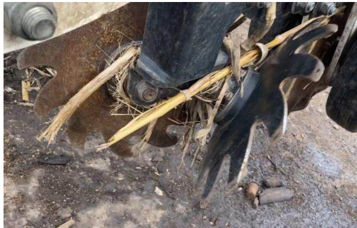
Рис. 4. Намотування рослинних решток кукурудзи на очиснику ряду агрегату SLY StripCat
