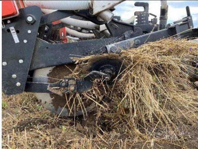
Рис. 3. Забивання перед лапою агрегату Kuhn Krause Gladiator
