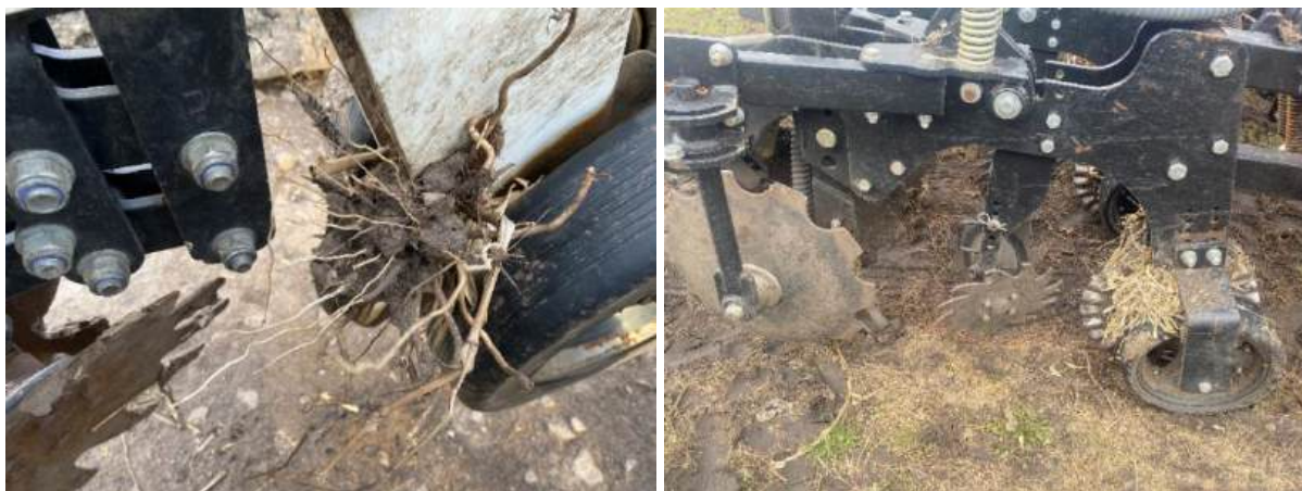
Рис. 1. Забивання між опорними колесами та рамою секції на якій закріплено култер. Агрегат: SLY StripCat та Yetter Maveric
