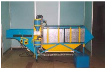
Зразки конструкції вібраційного молотильного пристрою на різних типах зернозбиральної техніки
