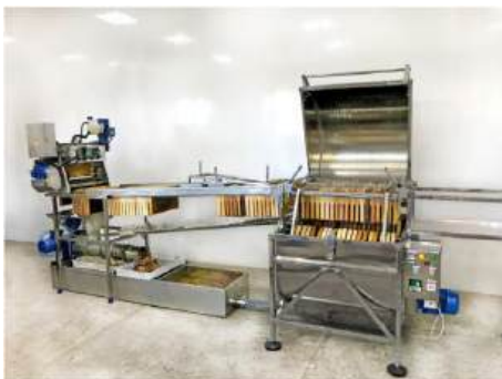
Загальний вид автоматичної лінії для відкачування меду
