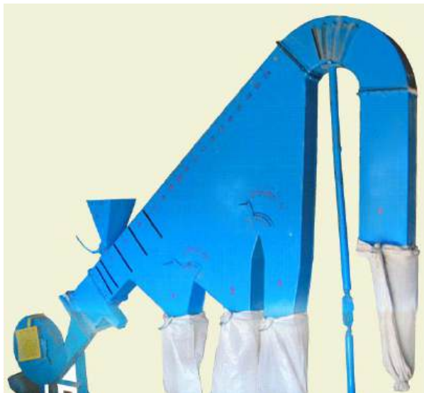
Загальний вид універсального пневматичного сепаратора
