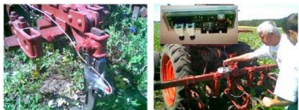
Мікроконтролерна система моніторингу параметрів робочих органів – польові дослідження
