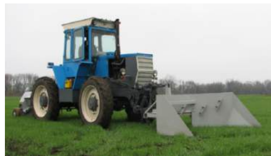
Валкувач-розкидач органічних добрив із роздільником куп в агрегаті з трактором ХТЗ-161
