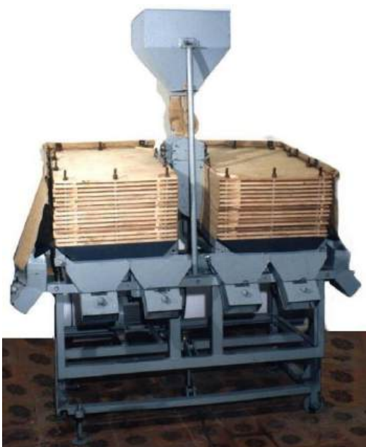
Загальний вигляд вібраційної насіннєочисної машини
