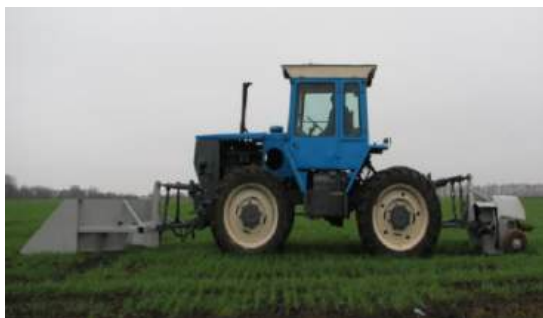
Валкувач-розкидач органічних добрив із роздільником куп в агрегаті з трактором ХТЗ-161
