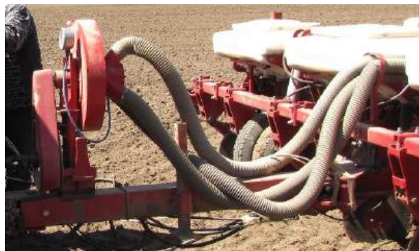
Запропонований відцентровий радіальний вентилятор у складі експериментальної просапної сівалки виробництва АТ «Ельворті»
