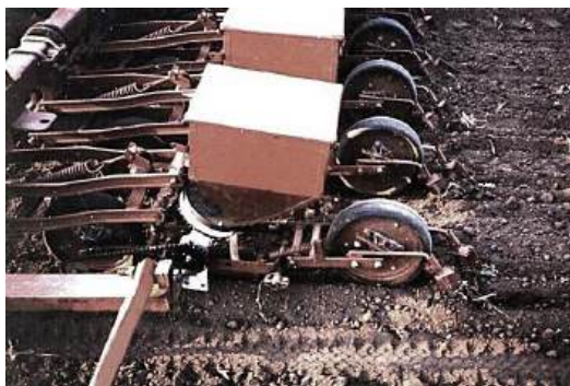
Загальний вигляд сівалки з вібраційно-дисковими висівними апаратами
