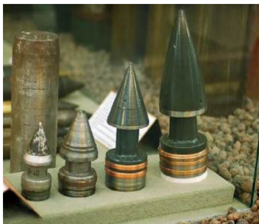
Рис.1. Котушкові підкаліберні снаряди для радянських гармат. Справа наліво: 57-мм, 76-мм, 85-мм, 100-мм.
