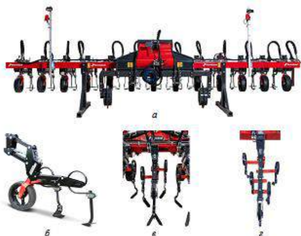
Рис. 1. Міжрядний культиватор Kverneland Onyx: а – загальний вигляд; б – секція культиватора; в – стійка з А-подібними плоскорізальними і L-подібними бічними лезами-бритвами; г – S-подібні SC-стійки
