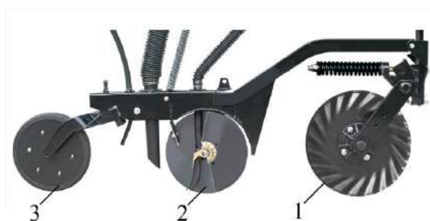
Рис. 2. Робочі органи дискової сівалки прямого сіву з колтером: 1 – колтер (турбо диск); 2 – дводисковий сошник; 3 – опрно-прикочувальне колесо
