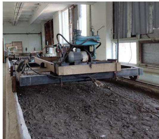
1 – напрямна поверхня; 2 – рама; 3 – ролики; 4 – начіпна рухома рама; 5 – дискові робочі органи; 6 – начіпна система; 7 – гідроначіпна система; 8 – приводна станція; 9 – канат; 10 – тензодатчик; 11 – опорне колесо
