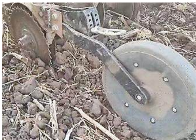
Рис. 1. Посів та заробка насіння експериментальним сошником з прикочувальним котком
