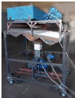
Рис. 1. Загальний вигляд вібропневмоімпульсного сепаратора
