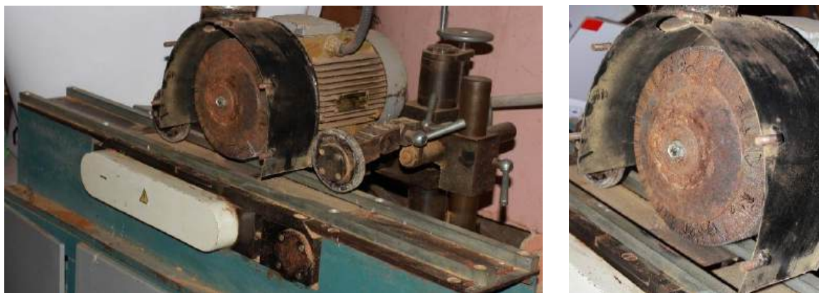
Рисунок 1 – Експериментальна установка з голкофрезою
