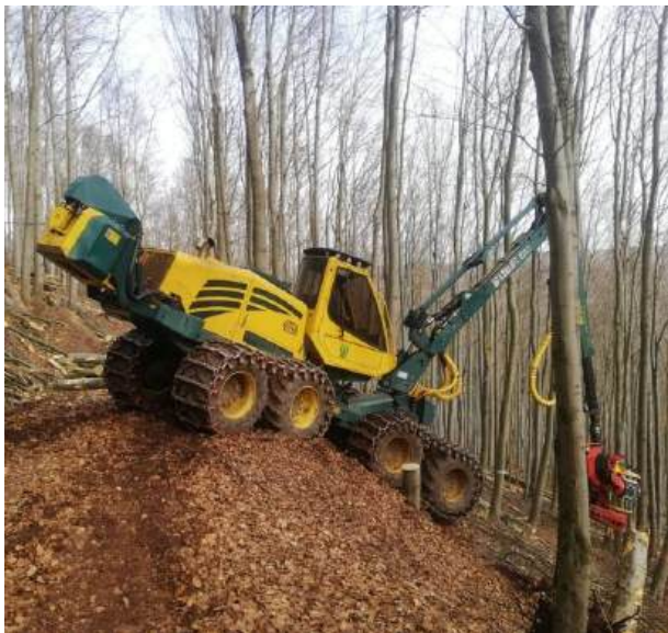
Рисунок 1 – Харвестер, оснащений допоміжною лебідкою для роботи на стрімких схилах
