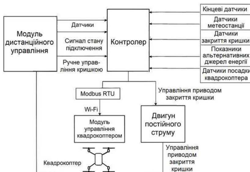
Рис. 1. Структурна схема системи керування
