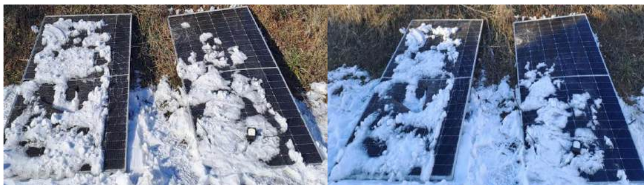
Рис. 3. Стан панелей 23.02.2025 о 15:00 (зліва) та о 16:00 (справа) – помітна різниця у швидкості очищення
