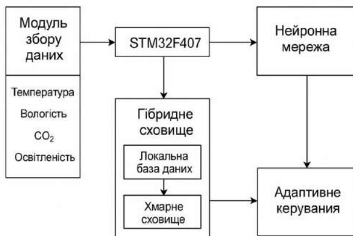
Рис. 1. Структурна схема системи підтримки мікроклімату
