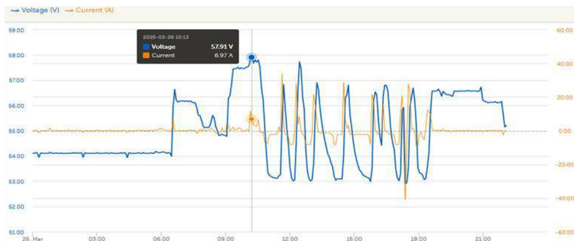
Рис. 2. Графіки моніторингу напруги на клеммах АКБ та струм заряду/розряду
