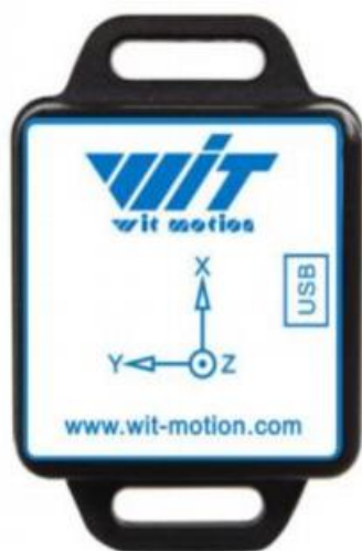
Рисунок 4.5 – Цифровий інклінометр із зазначенням осей обертання
