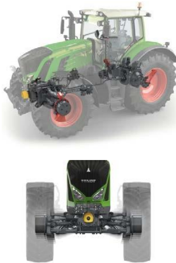
Рисунок 1.4 – Підвіски переднього моста з чотириланковим механізмом компанії Fendt
