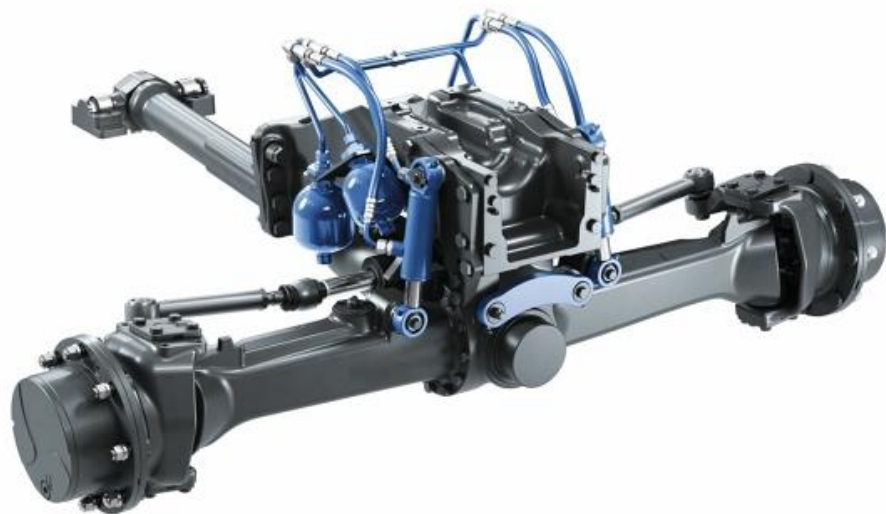
Рисунок 1.6 – Схема підвіски переднього моста трактора без поперечної тяги на тракторах Fendt
