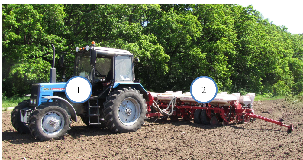
Рисунок 3.1 – Загальний вигляд посівного агрегату у складі трактора Б-1025.2 (1) та сівалки Vega-8 W Profi (2)
