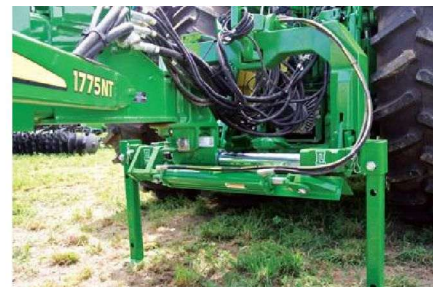
Рисунок 1.11 – Модернізований зчіпний пристрій Laforge (а) та DynaTrac CLASSIC (б)
