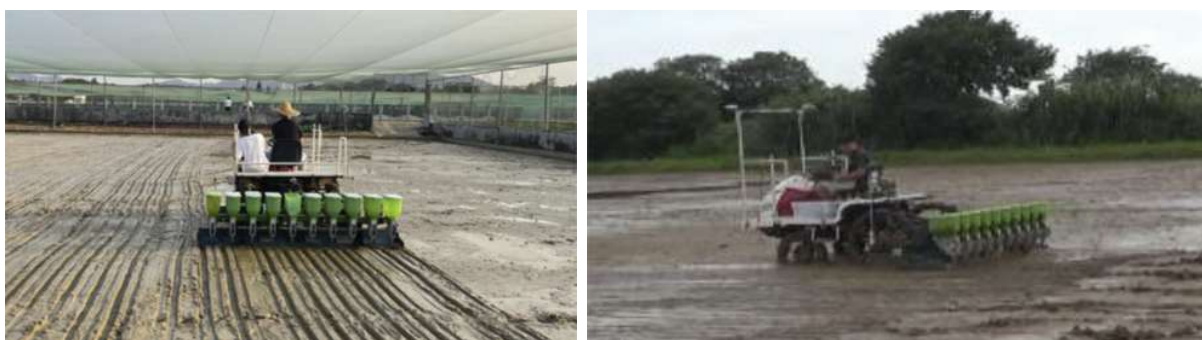
Рисунок 1.16 – Експериментальні дослідження вібрацій висіваючих апаратів посівного агрегату на полі з глинистим суглинком (а) та супісчаному полі (б)
