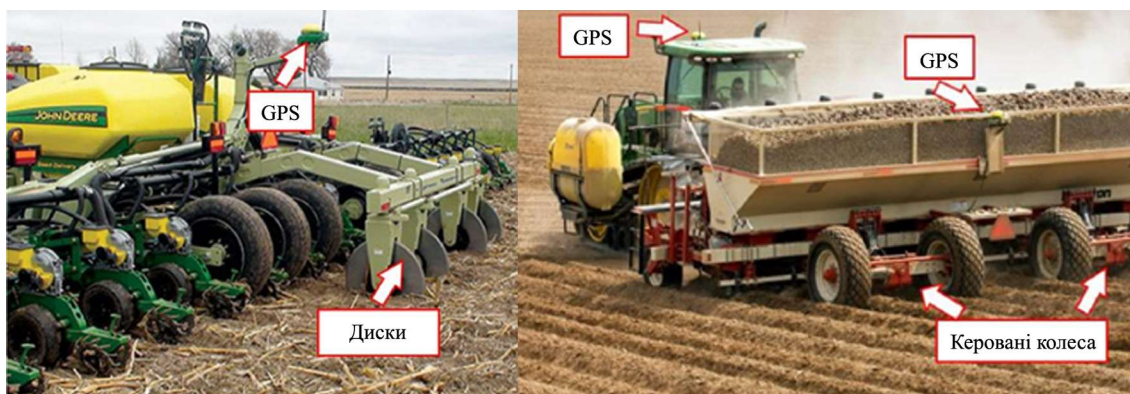
Рисунок 1.15 – Система керування напрямом руху знаряддя з дисками (а) та колесами (б)
