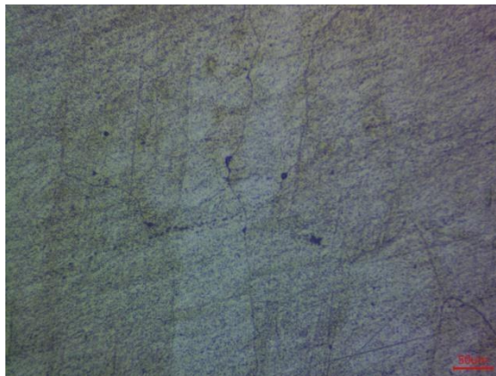
Рисунок 3.15 – Мікроструктура тонкого шару наплавленого металу з дроту №10 (×200)
