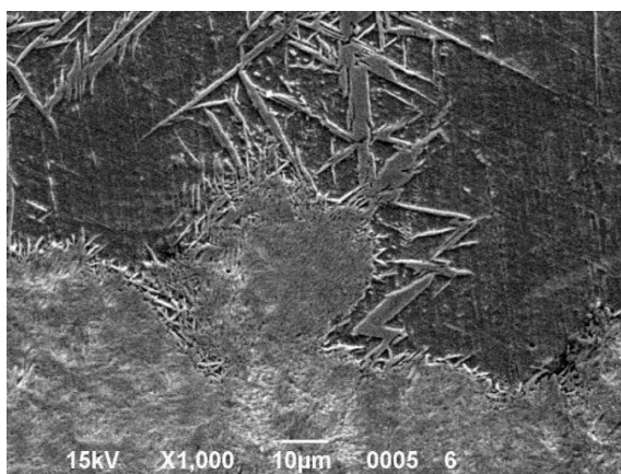
Рисунок 3.39 – Мікроструктура серійного зразка після абразивного випробування
