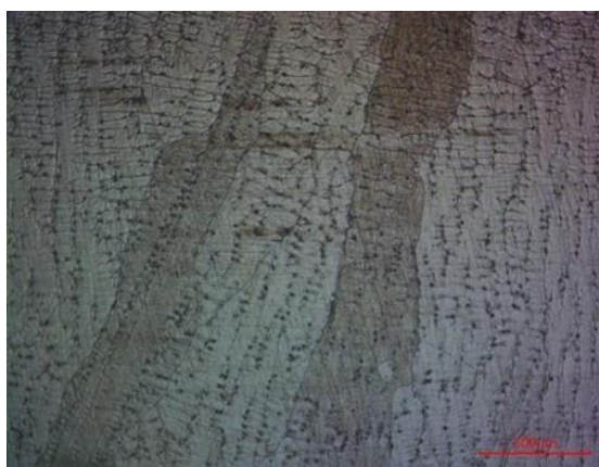
Рисунок 3.36 – Мікроструктура металу з 2% графіту
