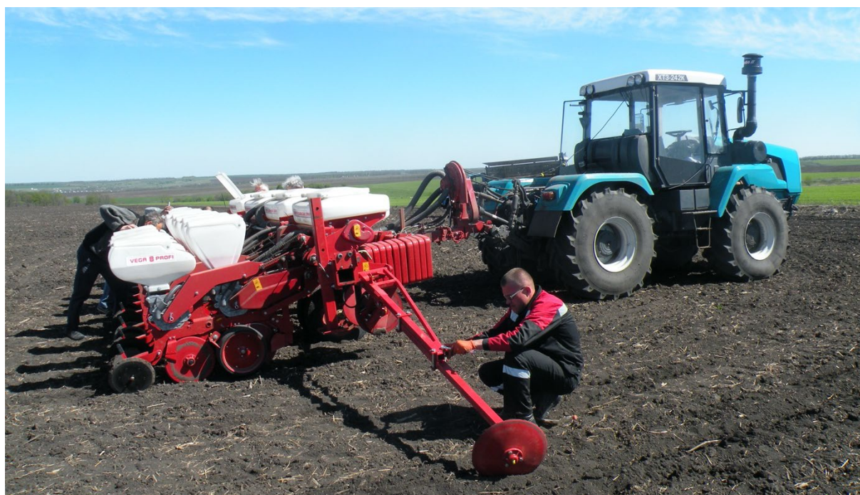
Рисунок 5.1 – Посівний агрегат на базі розробленої у співпраці із АТ «Ельворті» пневматично сівалки для сумісного висіву двох і більше просапних культур та експериментального трактора ХТЗ-242К із безступінчастою двопоточною трансмісією виробництва ХТЗ (м. Харків)
