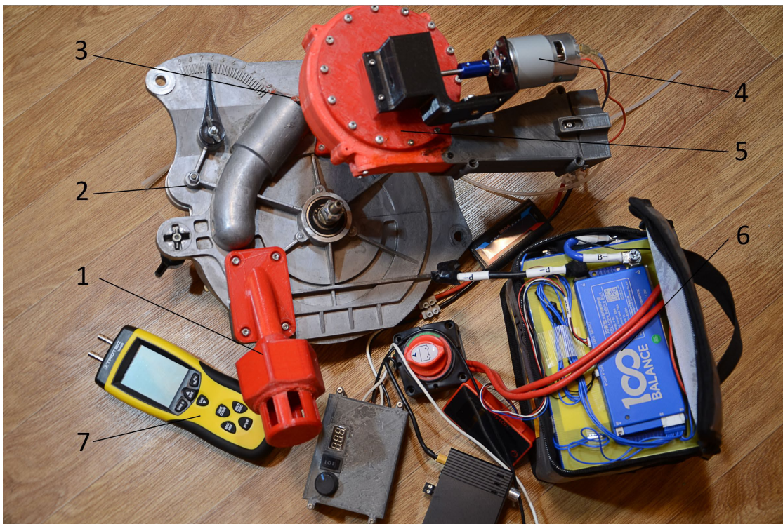
Рисунок 4.5 – Модель ПССБТ ІВРВ: 1 – перепускний клапан; 2 – ВА; 3 – заглушка; 4 – електродвигун приводу ІВРВ; 5 – ІВРВ ( робоче колесо та раавлик); 6 – джерело живлення; 7 – дифманометр ТА400
