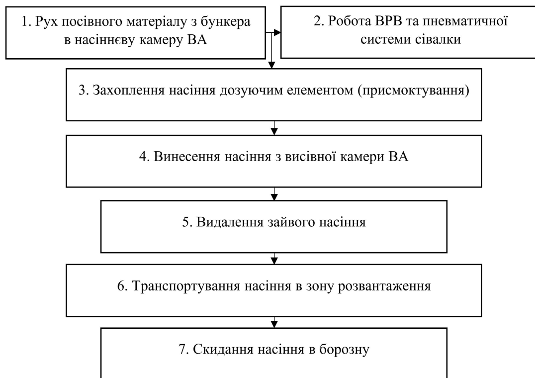
Рисунок 1.7 – Схема технологічного процесу роботи пневматичної системи з посіву насіння пневматичними сівалками
