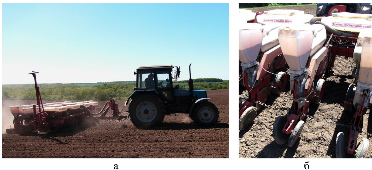
Рисунок 5.1 – Сівба просапних культур: а) посівний агрегат на базі трактора МТЗ-1221 та модернізованої сівалки VEGA 8 PROFI; б) посівна секція, модернізована під посів двох культур одночасно
