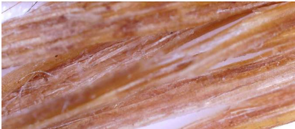
Рисунок 3 – Мікроструктура волокна хвої сосни звичайної
