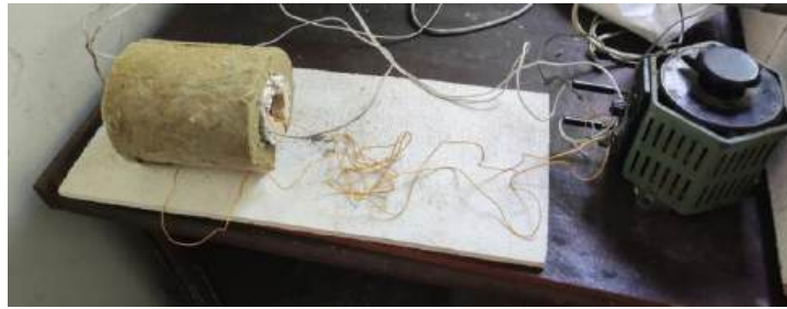
Рис. 2. Процес визначення теплопровідності зразка дерево-полімерного матеріалу під дією нагрівача
