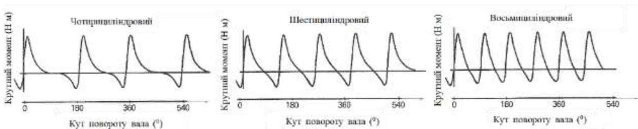
Рисунок 2 - Крутний момент колінчастого валу, визначений силою газу в циліндрах
