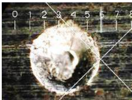
Рис. 1. Характер відбитків на зразках відновлених розточуванням з послідуємим хонінгуванням та гартуванням: ( \times 130 , в зворотному світлі)
