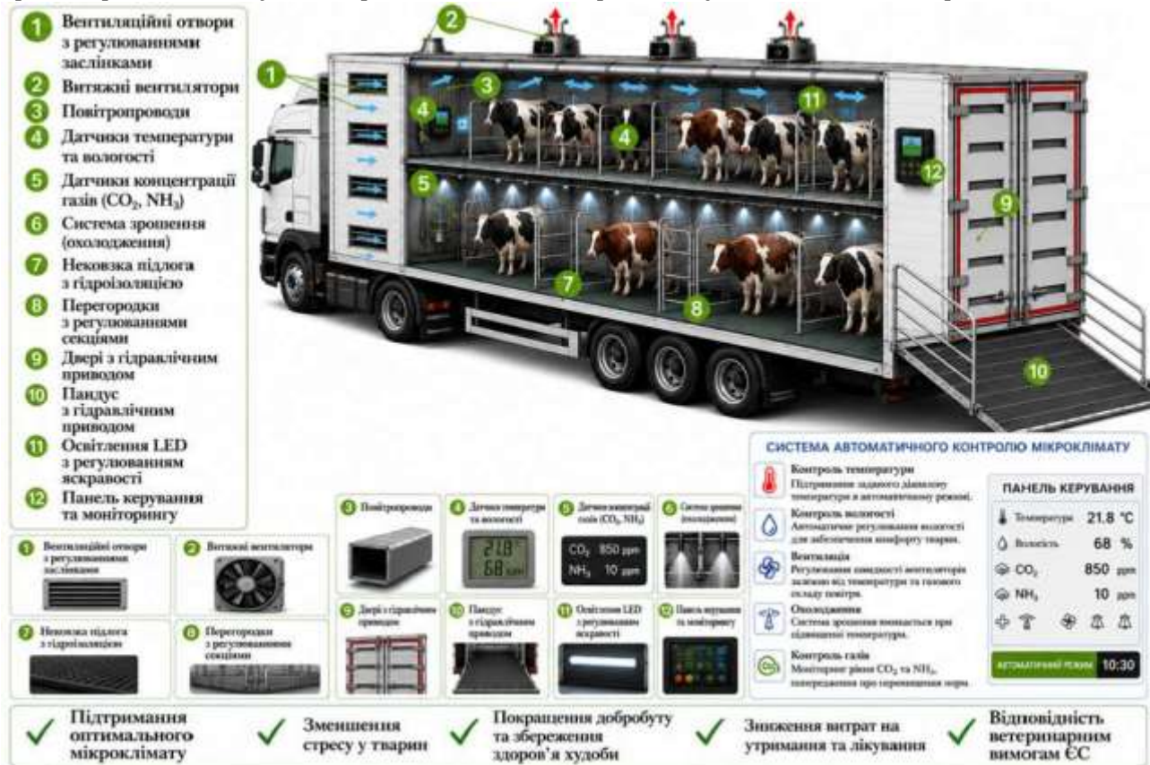
Рис. 1. - Схема сучасного транспортного засобу для перевезення великої рогатої худоби із системами вентиляції та автоматичного контролю мікроклімату
