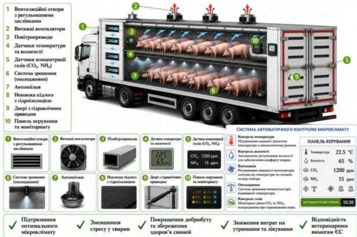
Рис. 1. - Схема сучасного транспортного засобу для перевезення свиней із системами вентиляції та автоматичного контролю мікроклімату
