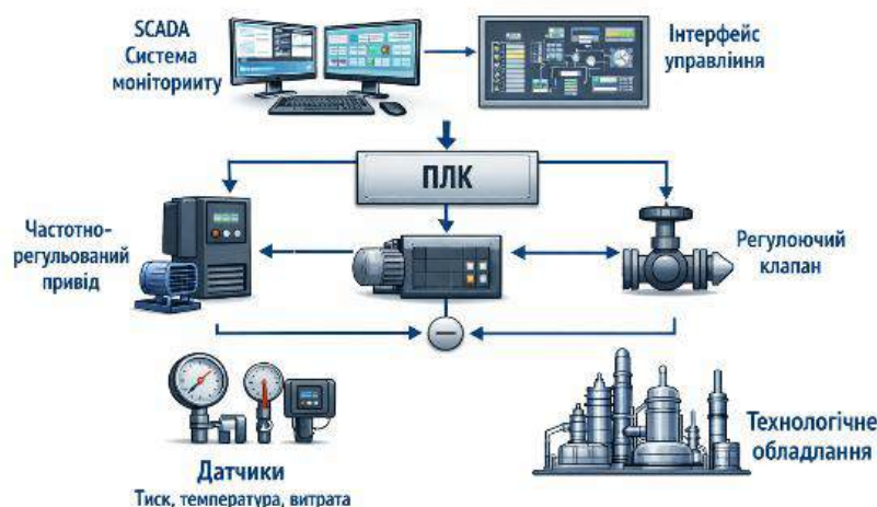
Рис. 4. Архітектура системи автоматизованого керування
