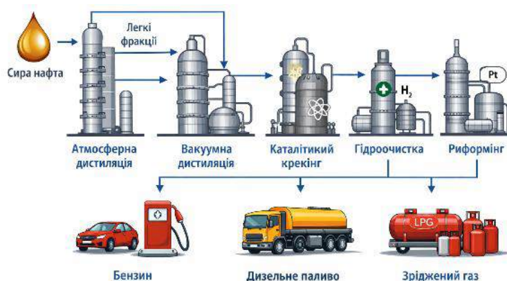
Рис. 1. Технологічний процес виготовлення моторного палива
