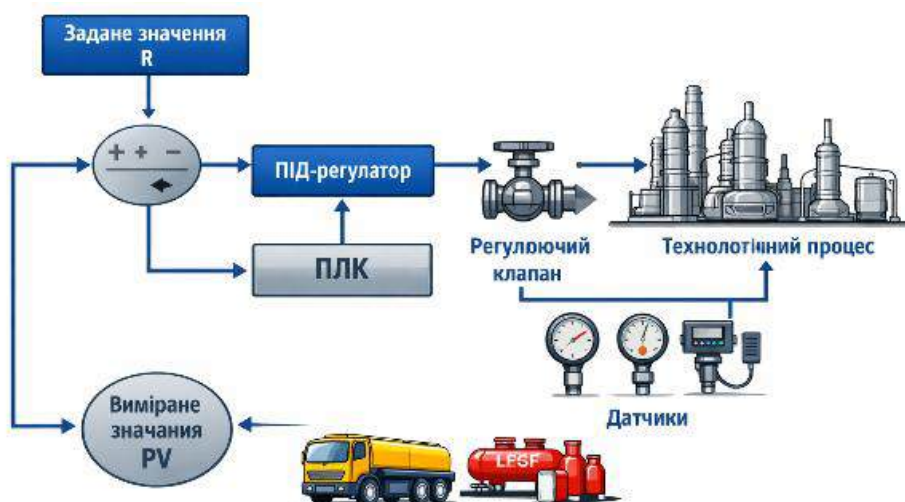
Рис. 2. Схема контуру автоматичного керування
