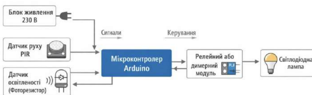
Рис. 1. Структурна схема системи керування освітленням на базі Arduino
