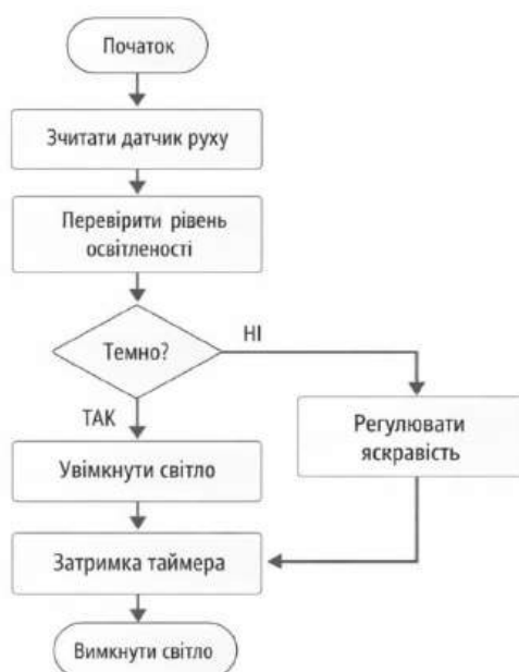
Рис. 2. Блок-схема алгоритму адаптивного керування освітленням
