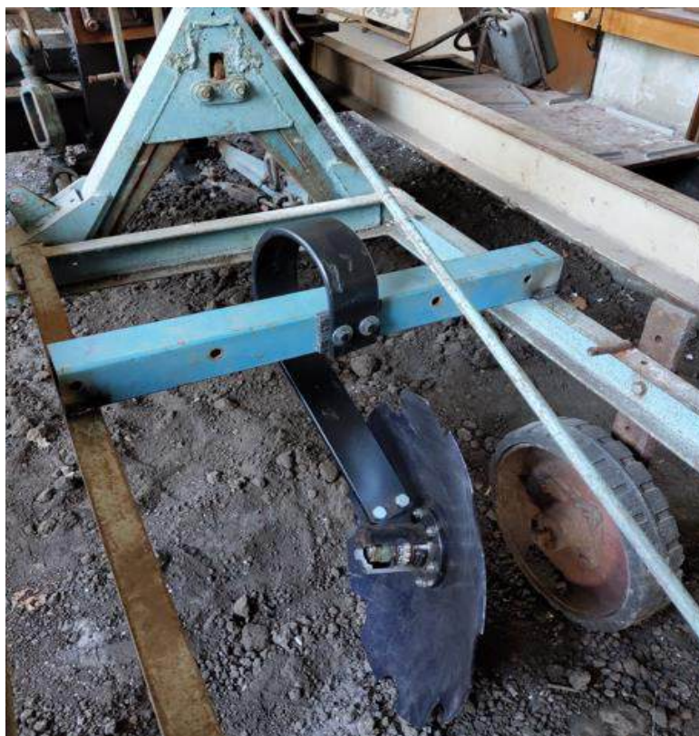
Рисунок 3.4 – Начіпна рухома рама для кріплення та регулювання глибини ходу дискових робочих органів
