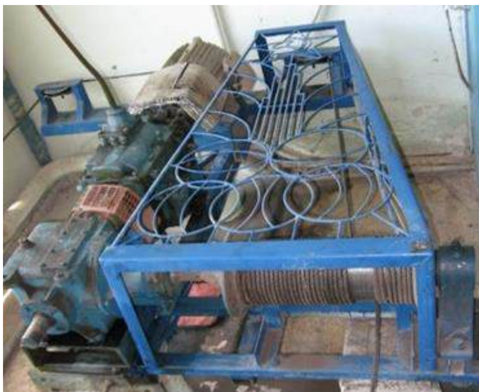
Рисунок 3.3 – Приводна станція рухомого модуля лабораторної установки
