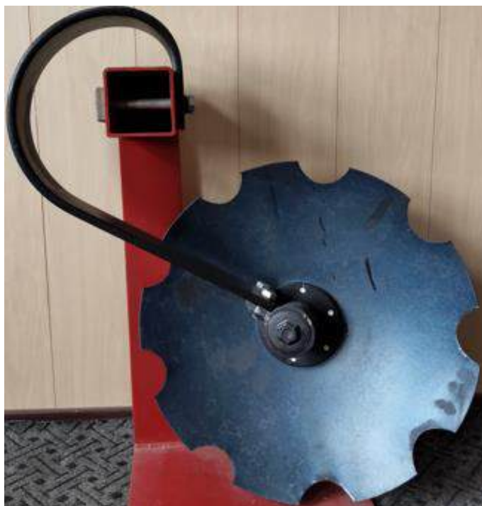
Рисунок 3.5 – Загальний вид дискового робочого органу, що випробовувався
