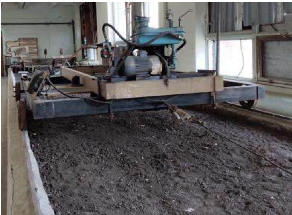
Рисунок 3.2 – Загальний вигляд ґрунтового каналу для проведення експериментальних дослідів
