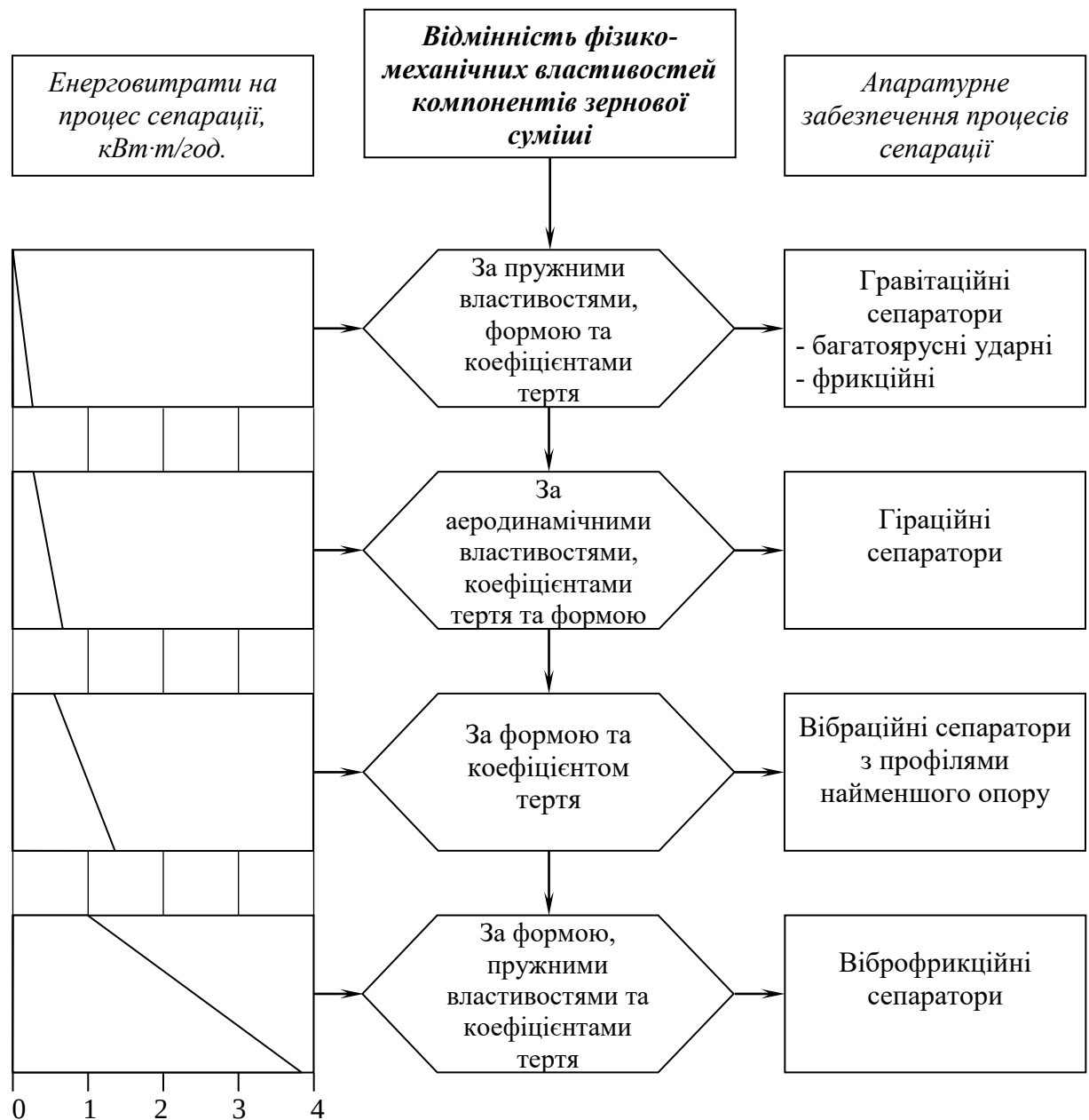
Рисунок 4.24 – Схема алгоритму сепарації важкороздільних зернових сумішей з діапазонами енерговитрат на процес сепарації
